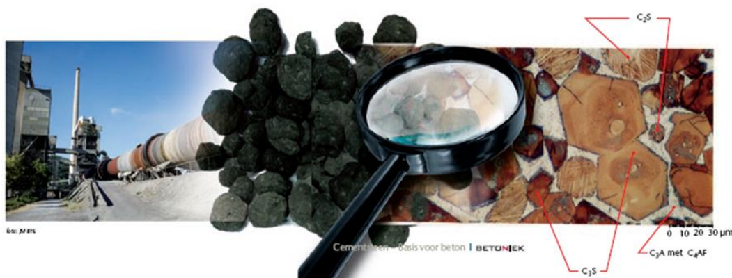
Figuur 4.20 In een cementoven wordt portlandcementklinker gemaakt. Deze bestaat uit de 4 klinkermineralen C_3S , C_2S , C_3A en C_4AF .
