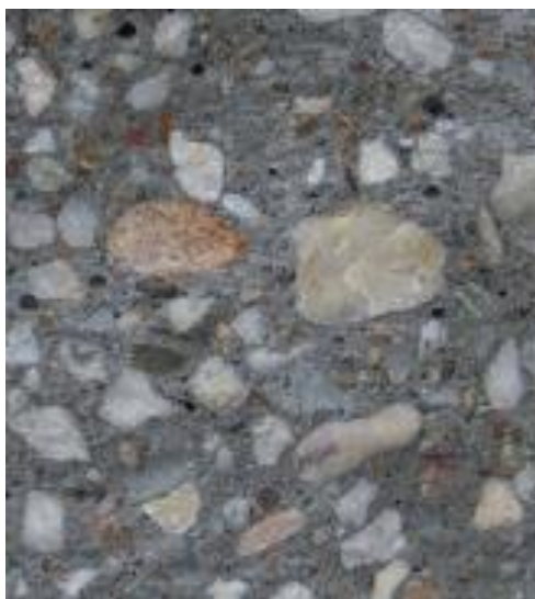
Figuur 4.2 Cementsteen in de verharde lijn tussen de toeslagkorrels.
