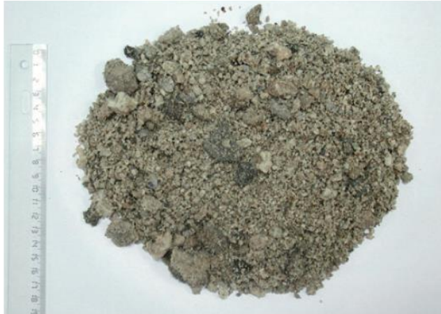
Figuur 4.27 Gegranuleerde hoogovenslak is nog geen fijn poeder!
